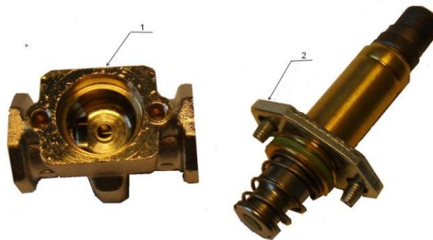
Рис. 24. Электромагнитный клапан (тип 2)
